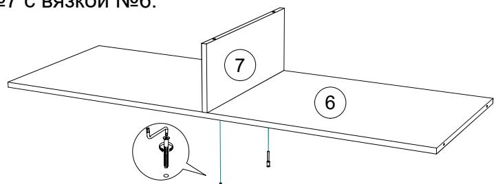
4. Далее этими же евровинтами соедините боковины №10, №11 и перегородки №8, №13 с крышкой №12. Вязку №6 с боковинами №10, №11. Перегородки №8, №13 соединяются с вязкой №6 шкантами. Также соединяется шкантами перегородка №7 с крышкой №9. Используя эксцентриковые стяжки соедините крышку №9 с боковинами №10, №11.
